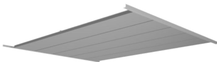
Falso techo metálico compuesto de paneles de aluminio o acero galvanizado perfilado y plegado en sus cuatro cantos en forma de bandeja lineal. Su montaje puede efectuarse apoyado en los extremos, sobre perfiles angulares o colocado con perfil soporte de acero galvanizado para el montaje de paneles con entrecalle cerrada, longitud hasta 6 metros.
