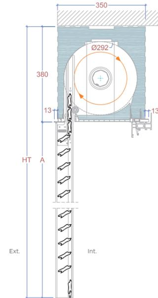
El cajón túnel ofrece un excelente aislamiento térmico y acústico llegando a satisfacer los estándares Passivhaus.
