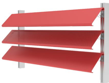
Celosía Phalsol Serie C 150 de lamas de aluminio extruido de alta calidad fijas (45°, 30°, 0°) y orientables. Material apropiado por su óptima resistencia a la intemperie, aceptando una gran cantidad de acabados tanto en anodizados como en colores de la gama RAL. Sección de lama de 150 x 20 mm.
